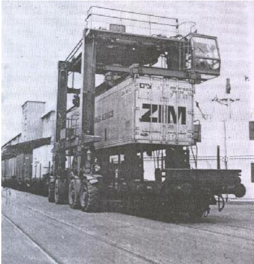
Utovar kontenera na vagon
