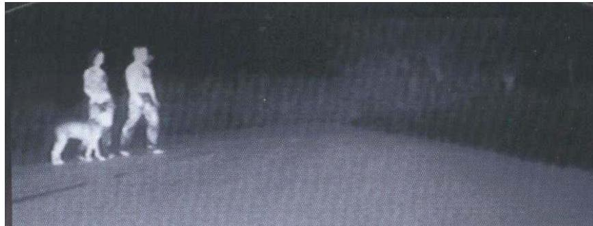
*Slika V.16 Slika dobijena infracrvenim snimanjem za povećanje vidljivosti pri noćnoj vožnji*
