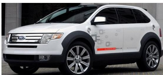
prvi vozni automobil koji kombinuje gorive ćelije sa električnim baterijama i najnovijom plug-in tehnologijom koja omogućuje punjenje litijum-jonske baterije za oko 8 sati. U Fordu kažu da ovaj Edge može preći oko 40 km koristeći samo bateriju, a kada
