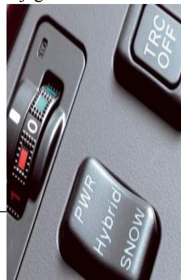
Normal, Power i Snow, reakcija na komandu gasa se osetno menja. Normal podrazumeva optimalni balans snage i trakcije, dok je kod Power moda odziv na pristikanje pedale gasa mnogo brži. Automobil postaje značajno "življi", baš kao što ga nasuprot ovome modu izbor onog sa oznakom Snow dosta "umrtvluje". Power mod omogućava da GS 450h nakon polaska iz mesta brzinu od 100 km/h postigne za 5,9 sekundi.
